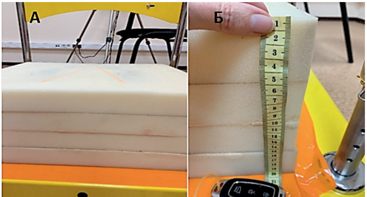
Рисунок 4 — Экспериментальное поролоновое основание для стабилотрической оценки статического равновесия.
