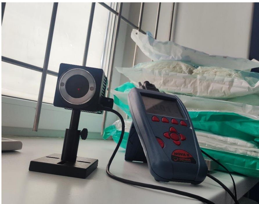
Рисунок 3 – Измерительная головка FL250A-BB-35 (OPHIR, Израиль) и измеритель мощности Nova II (OPHIR, Израиль)
