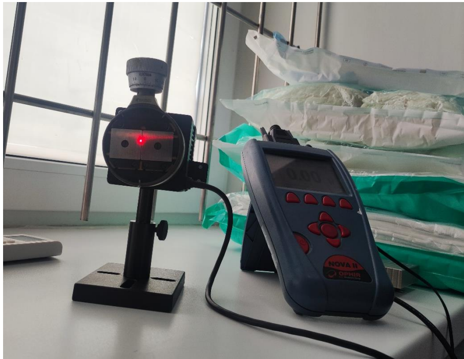
Рисунок 4 – Установка спектральной щели АЛ6.274.041 на измерительную головку FL250A-BB-35 (OPHIR, Израиль)
